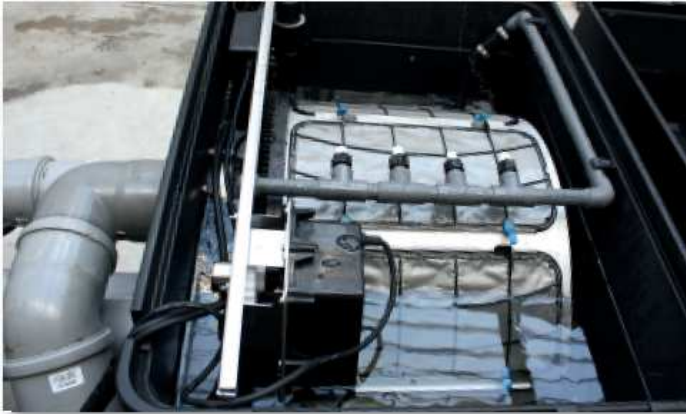
слева: насосная система барабанного фильтра
