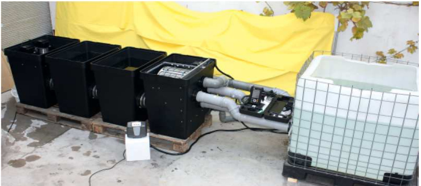
Тестовая установка с помощью расходомера и блока управления
